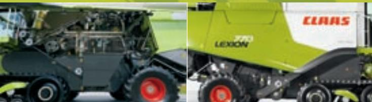
Durchgehende große Wartungsklappen. Leicht zu öffnen durch geringes Gewicht.
