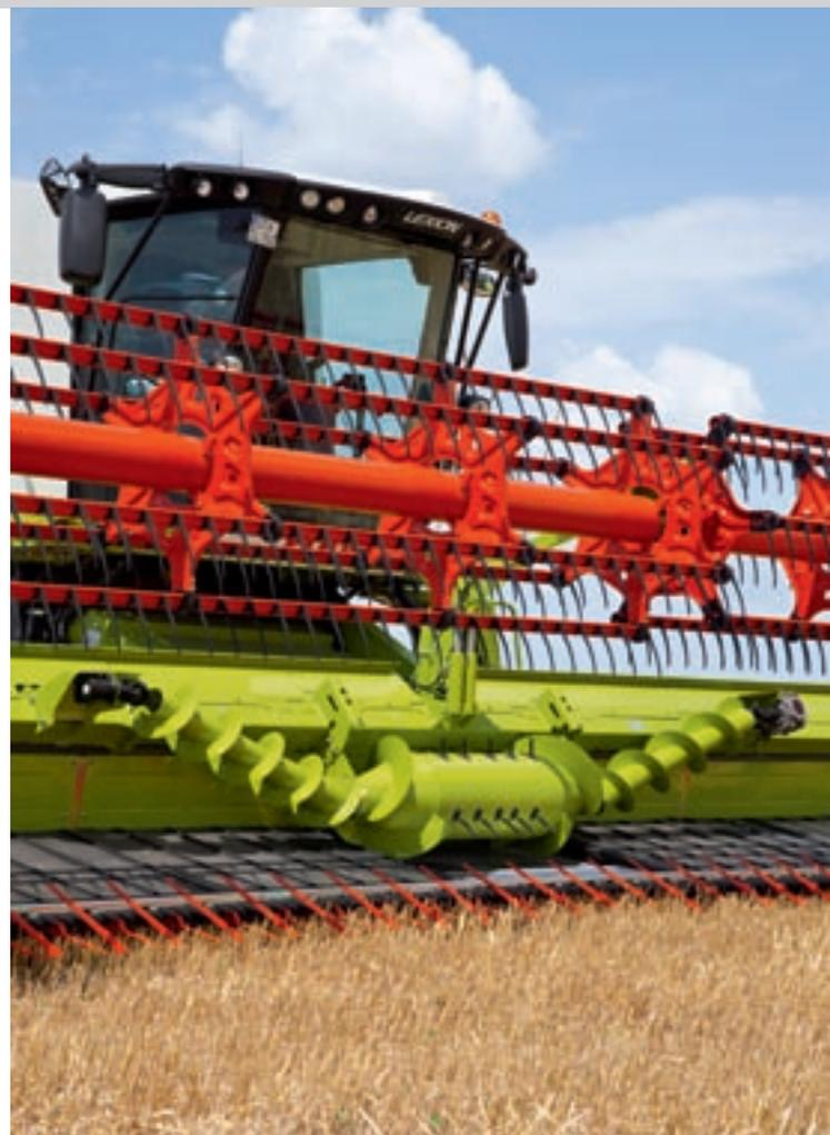
Durch das Führungselement wird das Material schonend in einer Kurvenbahn zugeführt.
