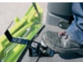
Die Differentialsperre ermöglicht ein sicheres Vorankommen, auch in extrem steilen Lagen. Zusätzliche Sicherheit bietet die nasse hydraulische Lamellenbremse.
